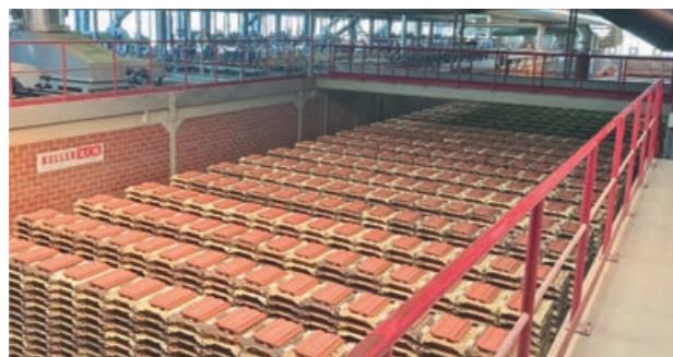
moderne H-Kassetten auf dem Brennwagen
